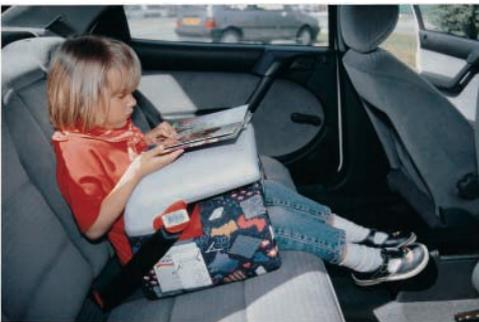
*L'enfant et le dispositif, qui prend appui de chaque côté des cuisses, sont retenus ensemble par la ceinture.* Ce dispositif est compatible avec la ceinture 3 points et constitue la solution pour transporter un troisième enfant sur la place centrale arrière du véhicule.
